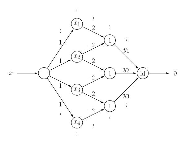
Ein neuronales Netz, das die Treppenfunktion von der vorherigen Folie berechnet. Es ist immer nur eine Stufe passend zum Eingabewert aktiv und die Stufenhöhe wird ausgegeben. Das Ausgabeneuron ist kein Schwellenwertelement: Seine Ausgabe ist die Identität der Neuroneingaben.
