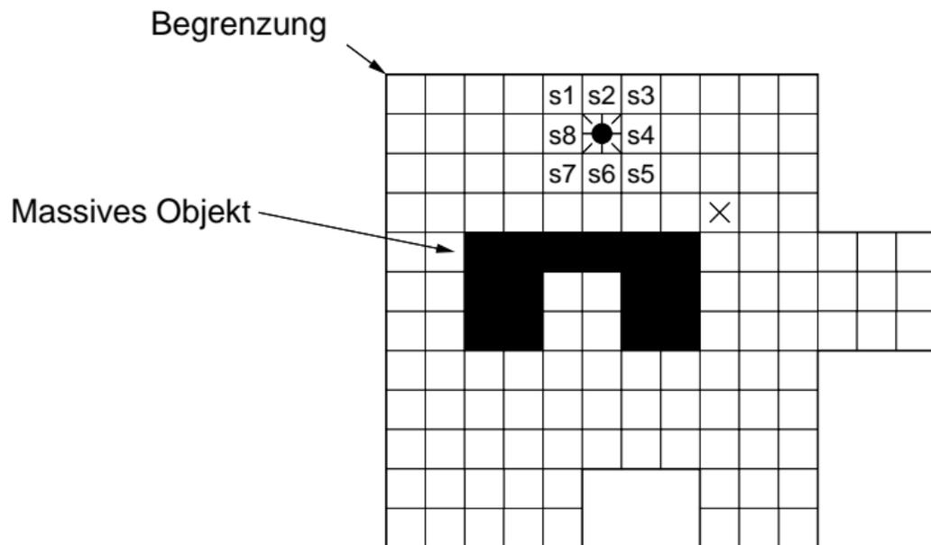
Der Roboter kann mit Hilfe der Sensoren  $s_1$  bis  $s_8$  feststellen, welche Zellen in seiner Nachbarschaft belegt sind.
