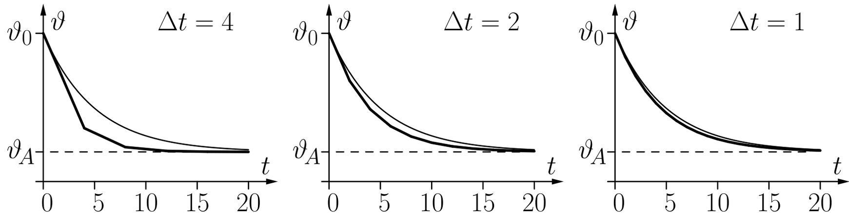
Die dünne Kurve ist die genaue analytische Lösung.
